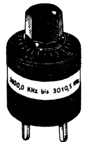
Bild 4 Variokristall in seinem Halter mit Drehknopf.
